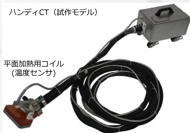
ボルト加熱用コイル (試作品)
